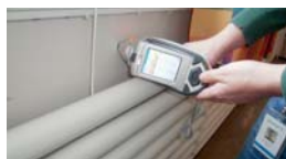
Bruk av "miljøpistol" under miljøkartlegging. Her for å avdekke metaller i maling (typisk bly og sink).
