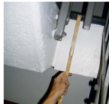
Måling av dekketykkelse gjøres enkelt i trapperommet.
